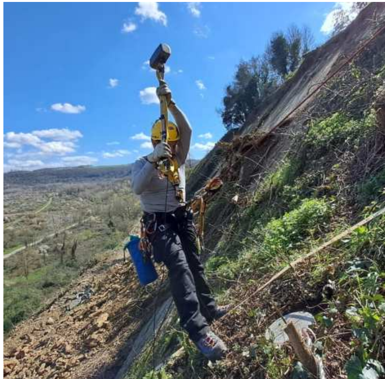
Figura 5 - Mazza da 8 kg battente su piastra per la generazione di onde P.
