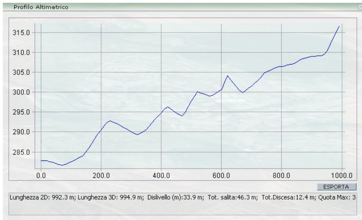
Figura 14 - Profilo altimetrico ed informazioni relative all'asta principale del Borro della Pozza dei Diavoli
