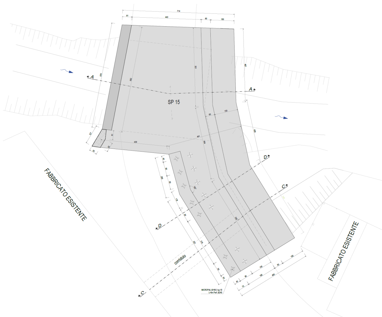
Figura 50 Stato di progetto - Carpenterie nuovo impalcato e cordoli
