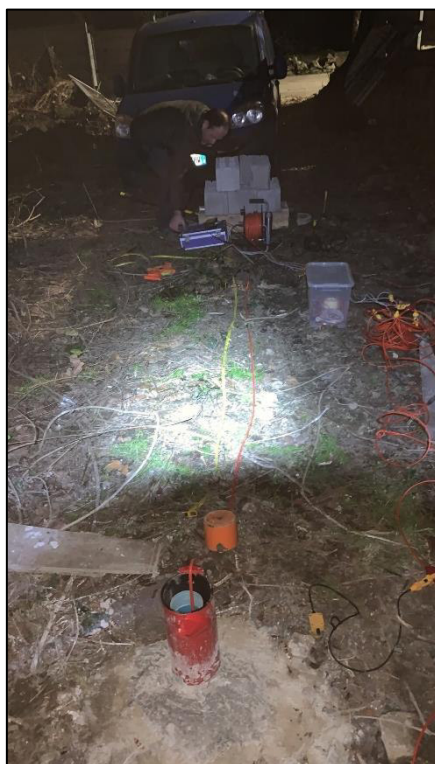
Foto – Indagine sismica Down-Hole (DH)
