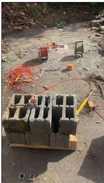
Foto – Indagine sismica attiva Down-Hole (DH)
